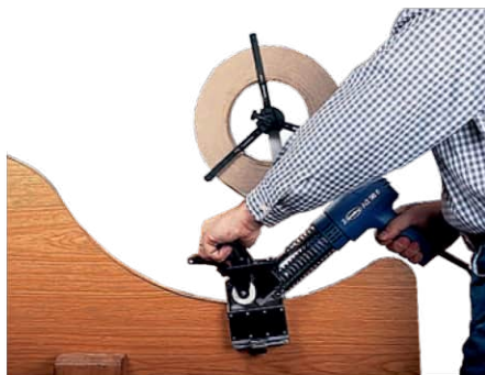
Teplovzdušná olepovačka pre pásy s naneseným lepidlom.
