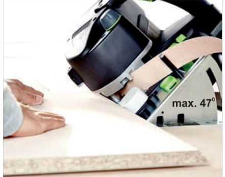
Stôl s doskou s klzným vedením pre použitie olepovačky conturo ako stacionárneho náradia. Možnosť naklápania od 0-47°.
